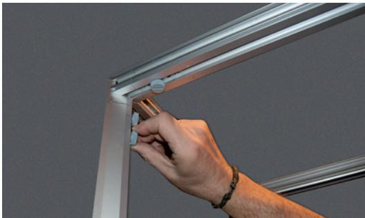
11. Verschrauben Sie das Deckelteil mit dem Unterbau.
