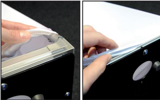
2. Führen Sie das Kederprofil in die vorgesehene Nut des Profils ein. Achten darauf, dass Hände entsprechend sauber sind um eine Verschmutzung vorzubeugen. Wiederholen Sie diesen Schritt an allen 4 Seiten
