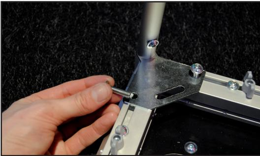
2. Befestigen Sie die Bodenstreben mit dem mitgelieferten langen Schrauben aus dem Befestigungsmaterial.
