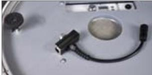
1. Das mitgelieferte DMX-Verteiler-Kabel wird ebenfalls auf der Unterseite der Technik-Plattform verkabelt.
