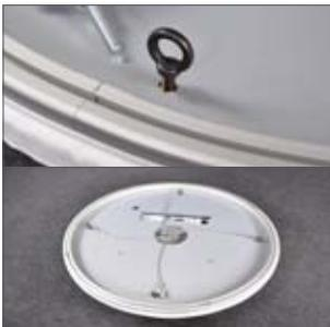
2. In die Öffnung werden die Ringschrauben eingedreht.
